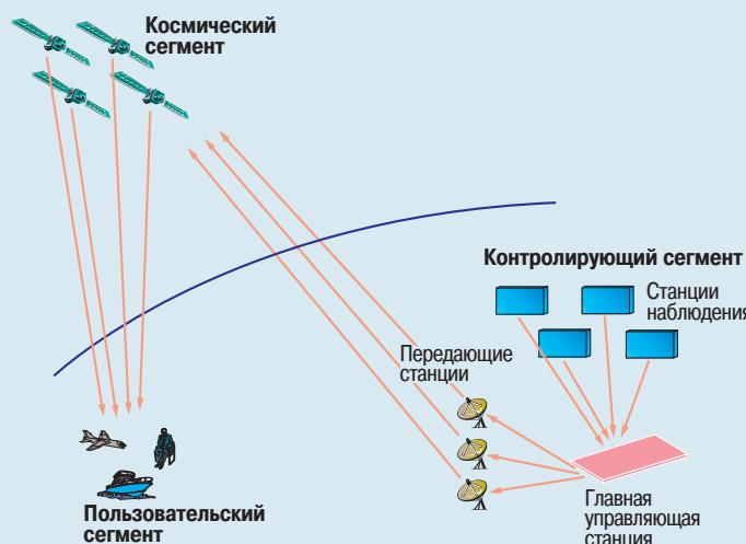
Радионавигационная система состоит из спутников, комплексов наблюдения, управления и контроля
