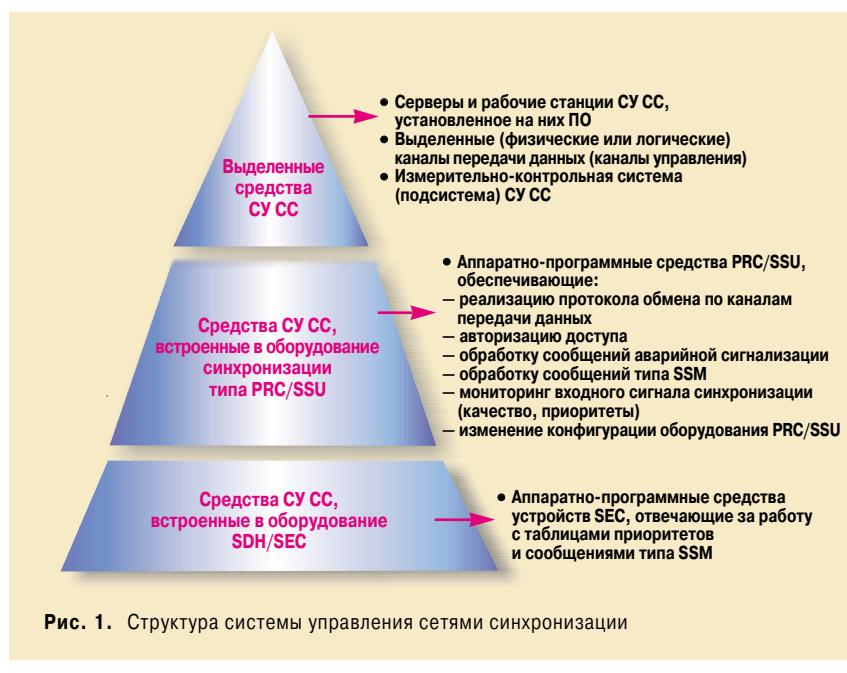
Рис. 1. Структура системы управления сетями синхронизации
